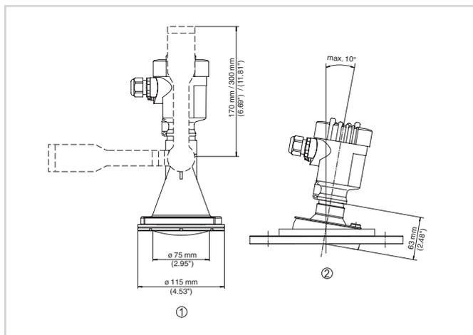
VEGAPULS 69, оправленная металлом линзовая антенна во фланцевом исполнении
